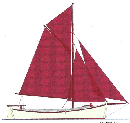
Schéma du Frihou - grand-voile aurique et son pic (corne) permettant de la hisser avec deux drisses. Au-dessus : le flèche. Foc et trinquette à l'avant. Surface vélique de 28,3 m2.
